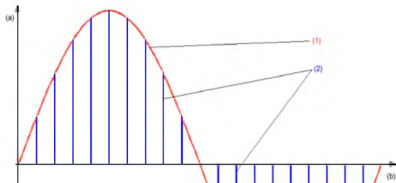
Рис. 8. Дискретизация: 1 – сигнал; 2 – отсчеты
