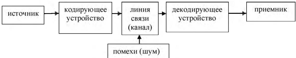
Рис. 7. Схема процесса передачи информации
