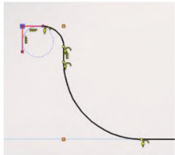
Рис. 24. Скругление верхних углов
