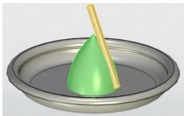
Рис. 29. Вычитание из конуса цилиндра
